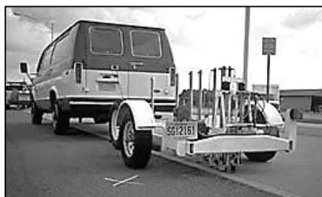
a. Seismic Pavement Analyser [26]
