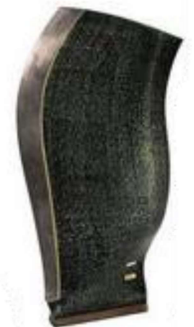
Left: LEAP-X fan Right: LEAP-X 3D woven composite fan blade
